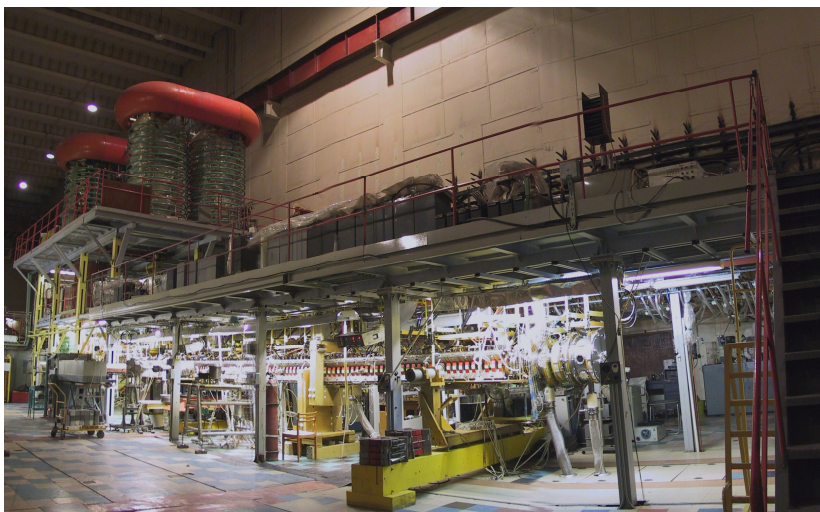
Рис. 9. Установка ГОЛ-3. Слева виден генератор мощного микросекундного ленточного пучка У-2, внизу под антресолю находится многобронная ловушка с плотной плазмой
