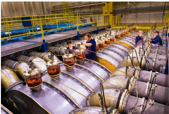
Рис. 2. Установка HERMES III. Справа и слева видны подводы формирующих линий к линейному индукционному трансформатору (в центре), который формирует импульс напряжения на вакуумной магнитно-изолированной линии, питающей электронный диод
