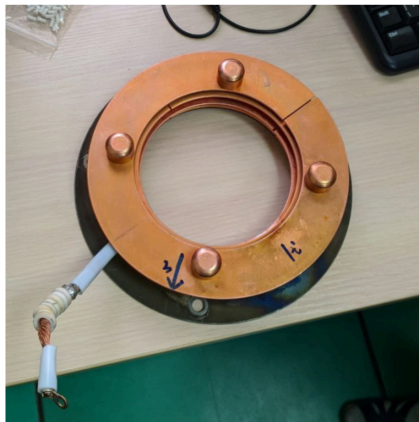
(б) Фотография лимитера в сборе.
