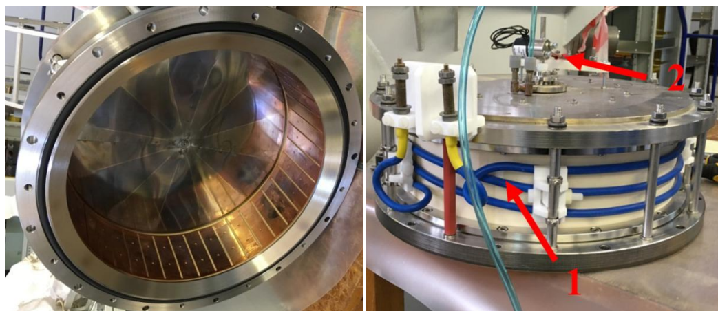
Рис. 5 ВЧ плазменный эмиттер. Слева – вид внутри, справа – вид снаружи: 1 – антенна, 2 – клапан и узел поджига.
