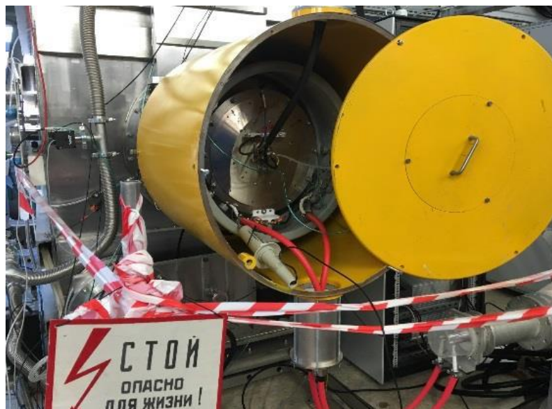
Рис.12 Инжектор с плазменным эмиттером, закрытым магнитным и электростатическим экранами.
