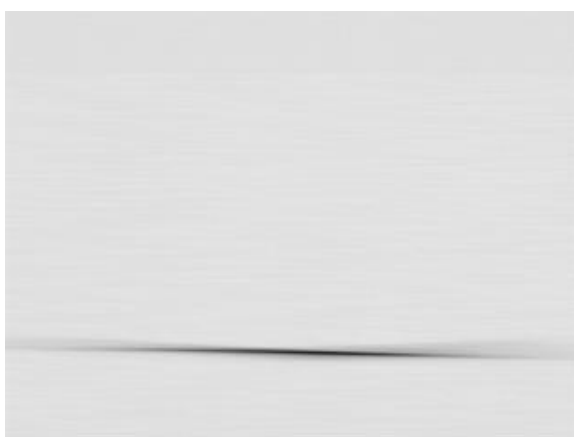
Рис. 22 Спектральная линия H_{\alpha} , полученная в режиме высокого магнитного поля
