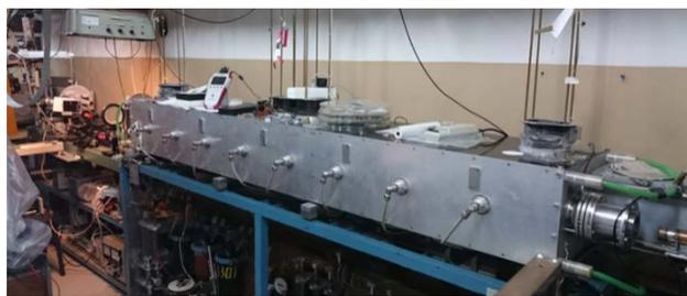
Рис.7.6.1. Сверхдлинный вакуумный волноводный резонансный интерферометр Фабри-Перо – модернизированный оптический резонатор универсального газового лазера.
