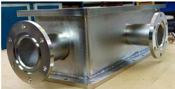
Рис. 4.3.1. Коллекторный узел генератора
