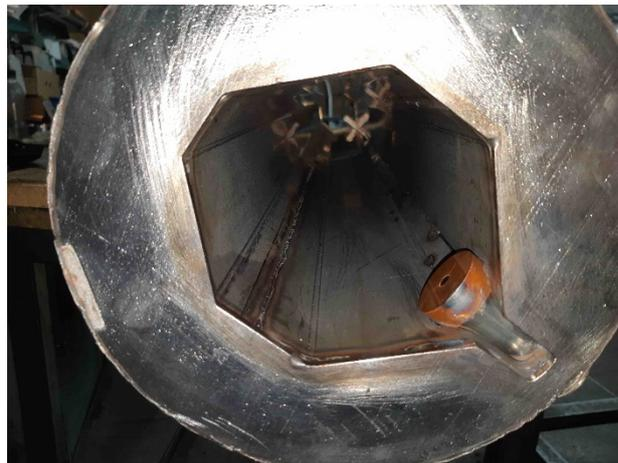
Рис. 5.2.7. Вакуумная камера и приёмник излучения внутри квадрупольной линзы NEL1.
