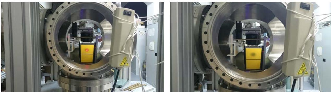
Рис.7.5.1. Пучки терагерцового и видимого излучения на термофлюоресцентном экране внутри камеры для исследования применений оптического разряда (слева), пучок терагерцового излучения на этом же экране (справа).
