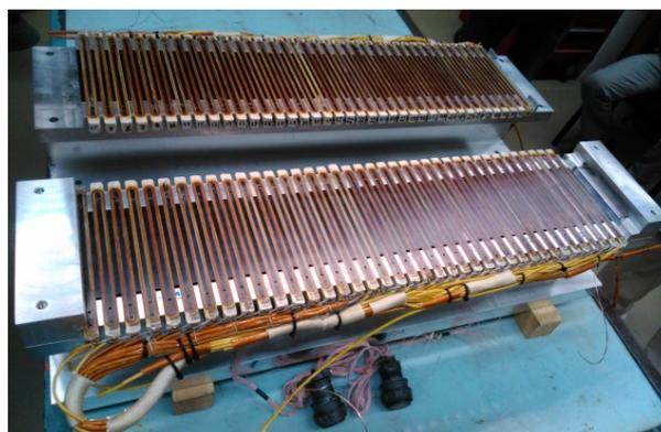
Рис. 6.2.3. Магнитная система прототипа сверхпроводящего ондулятора с периодом 15,6 мм и амплитудой поля 1,2 Тл по контракту с синхротроном Diamond Light Source (DLS, Англия).
