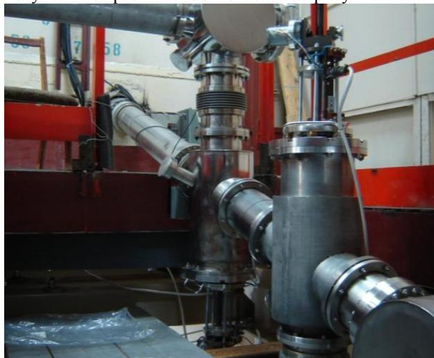
Рис.7.1.4. Система переключения излучения от разных ЛСЭ. Излучение всех ЛСЭ выводится на одни и те же пользовательские станции. Переключение между ЛСЭ осуществляется за счёт убирающихся зеркал.
