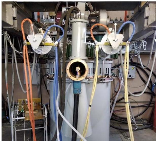
Рис. 8.1.2. Верхняя часть ускорителя ИЛУ-10М2 в бункере, видны 3 высокочастотных генератора.
