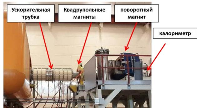
Рис.4.7.1. Ускорительная трубка стенда 1 МэВ пучка отрицательных ионов, секция транспортировки с квадрупольными магнитами, поворотный магнит и калориметр для исследования доускорения пучка в ускорительной трубке.
