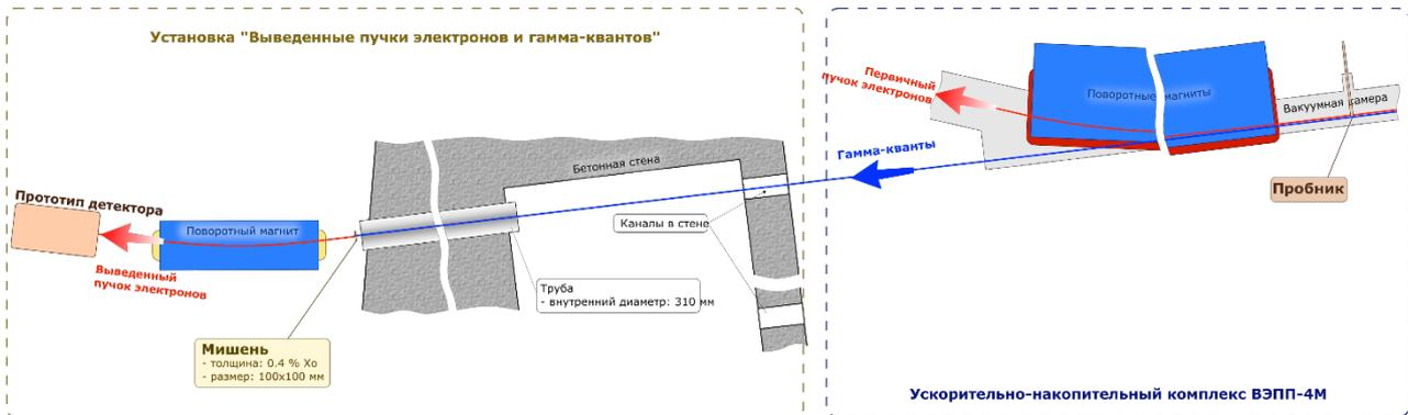
Рис. 5.2.9. Схема установки «Выведенный пучок».
