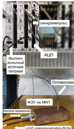
Рис.5.4.17. а) Схема расположение датчика потерь пучка в канале транспортировки К-500, б) элементы системы диагностики потерь.
