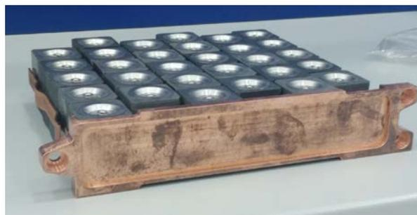
Рис. 4.5.2. Фотография полноразмерного макета защитной кассеты ДЗМ с керамикой карбида бора.
