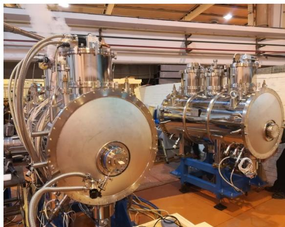
Рис. 6.2.2. Сверхпроводящие 54-полюсные вигглеры с косвенным охлаждением с полем 3 Тл и периодом 48 мм во время проведения тестирования на территории Курчатовского источника СИ.
