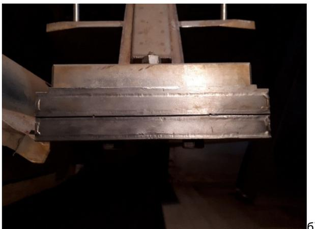
Рис. 8.2.1. Рамка с радиусным (а) и плоским (б) уплотнением фольги.
