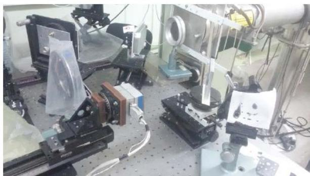
Рис.7.3.1. Оптическая система для измерения характеристик элементов свободной формы.
