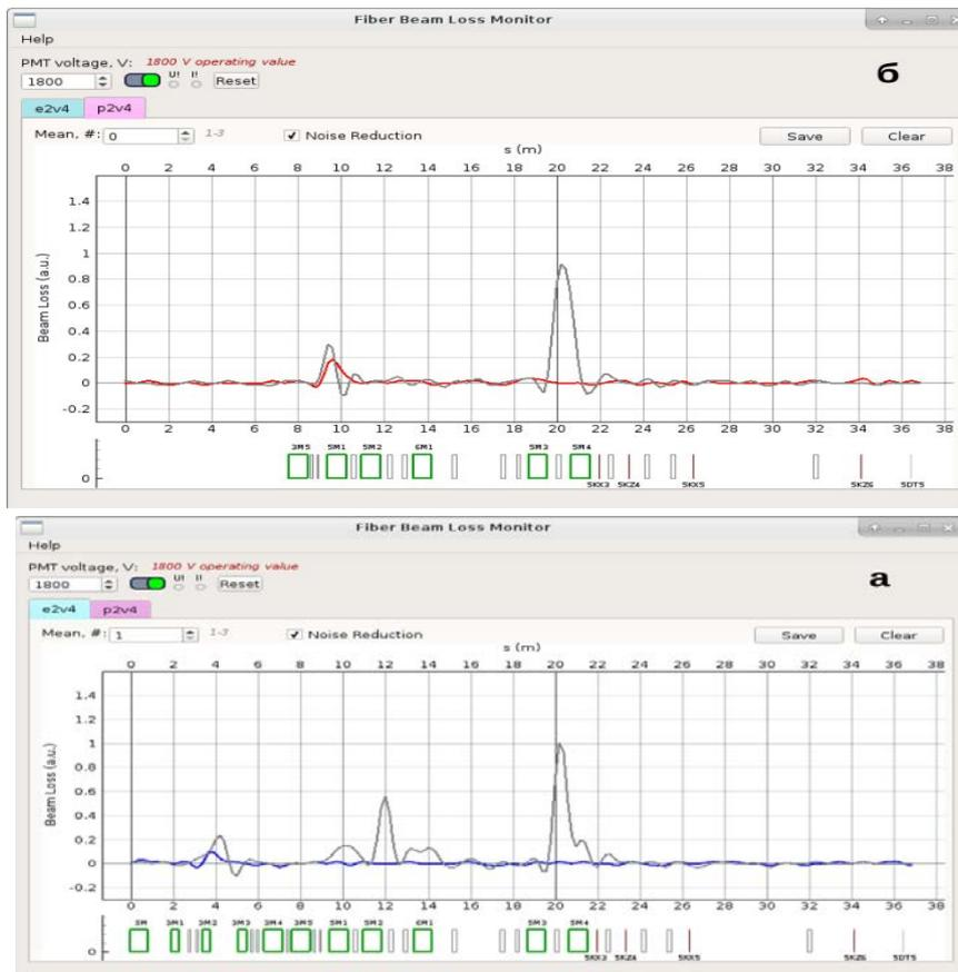
Рис.5.4.18. Окно вывода данных для распределения потерь пучка по каналу К-500 в направлении ВЭПП-4М в процессе наладки выпуска электронов (а) и позитронов (б). Серой линией обозначены потери, вызванные магнитной коррекцией диполей, цветной – достигнутая оптимальная настройка канала.
