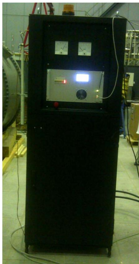
Рис. 10.4.1. Импульсный источник тока для короткого септум магнита на испытаниях в ИЯФ.
