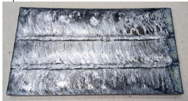
Рис. 8.2.3. Пластины размерами 300x150x12 мм с наплавленным слоем состава 16%Ta-5%Nb-3%Al-0,5%V, основа - титановый сплав ВТ14.
