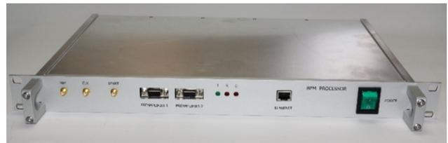
Рис. 1.2.4. Блок обработки сигналов пикапов кулера.
