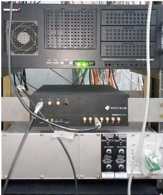
Рис. 5.2.21. Радио-стойка с серверным компьютером, с электроникой для NPCT и быстрым АЦП для оцифровки сигнала с FCT.
