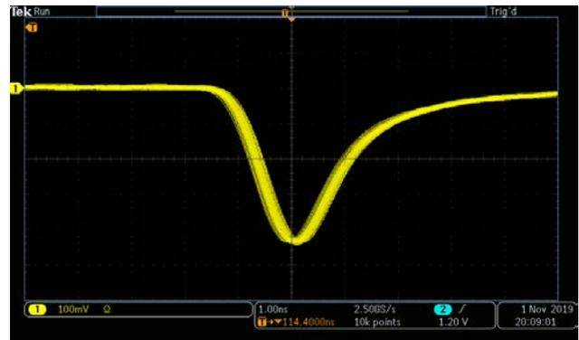
Рис. 5.2.23: Наблюдение нестабильности фазы напряжения ВЧ на ускоряющих резонаторах относительно опорного сигнала.
