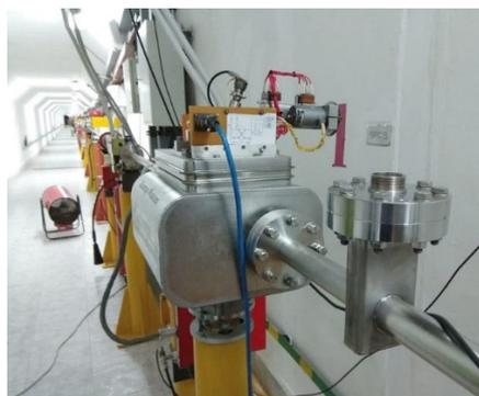
Рис. 5.1.6. Датчик ИПП установлен в канале К-500 перед подъёмом в зал БЭП.
