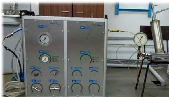
Рис. 4.5.5. Стенд гидравлических испытаний (слева) и макет камеры деления нейтронной диагностики.
