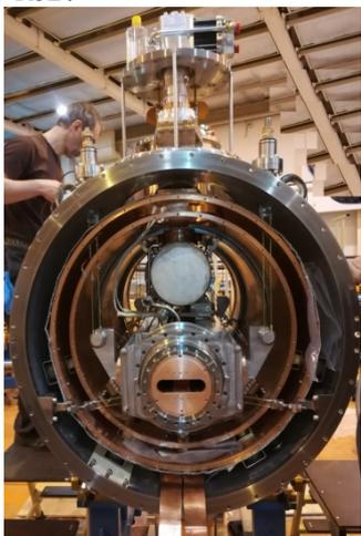
Рис.6.2.1. Процесс сборки сверхпроводящего 54-полюсного вигглера с косвенным охлаждением с полем 3 Тл и периодом 48 мм на территории Курчатовского источника СИ.
