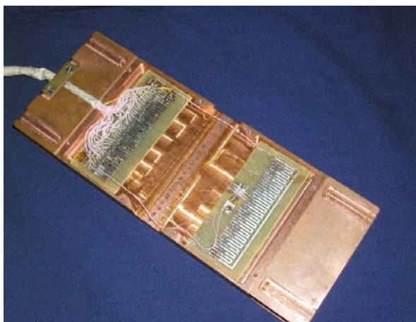
Рис. 4.1. Блок датчиков Холла (верхняя крышка снята).
