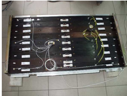
Рис. 35. Фото поверхности октанта перед установкой в детектор. Слева видны датчики температуры и влажности, выходы которых собираются на специальный разъём. Справа видна система продува модулей воздухом.
