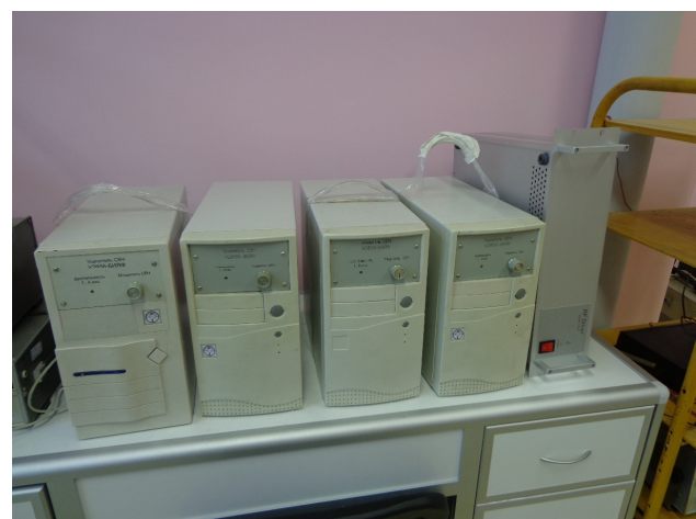
Рисунок 28. Вид используемых возбуждающих предусилителей (использованы корпуса от персональных компьютеров – слева, запасной блок в новом корпусе – справа).
