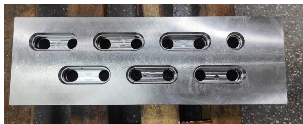
Рисунок 2. Блок контрольный, содержащий основные виды крышек водяных каналов ДЗМ, подходящие по размерам для всех видов контроля сварных соединений и для контроля герметичности.
