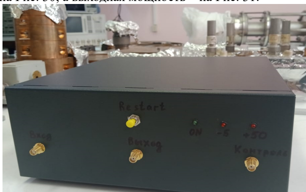
Рисунок 30. Изготовленный предусилитель клистрона.
