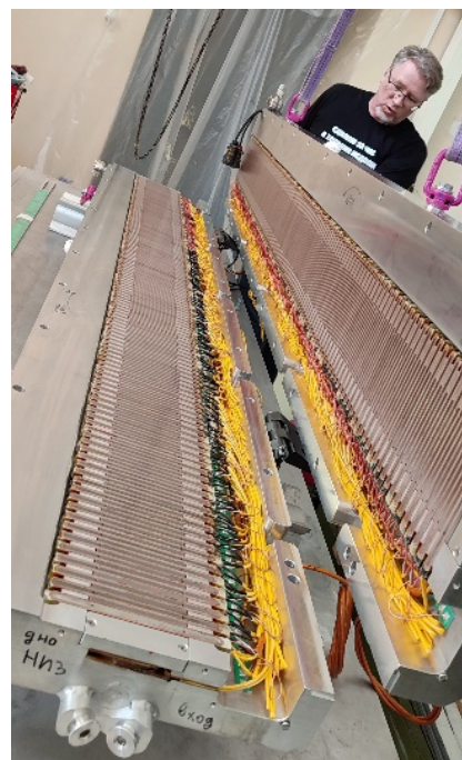
Рисунок 1. Внешний вид сверхпроводящего магнита с рабочим полем 2,7 Тл и периодом 27 мм в процессе сборки.
