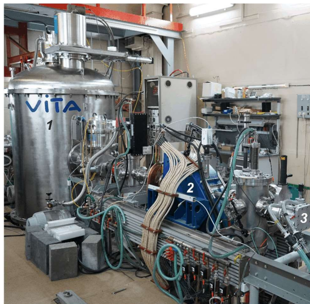
Рисунок 2. Фотография ускорительного источника нейтронов VITA на площадке в ИЯФ СО РАН: 1 – ускоритель-тандем с вакуумной изоляцией, 2 – поворотный магнит, 3 – литиевая мишень
