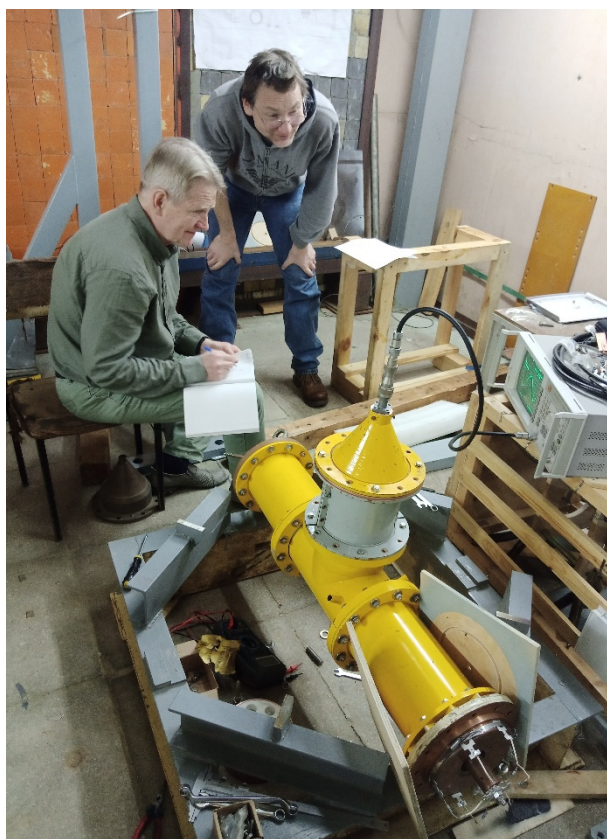
Рисунок 2. Измерение параметров узла ввода ВЧ мощности в ускоряющую структуру.
