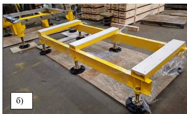
Рисунок 4. Вспомогательное оборудование для работы с диагностическим защитным модулем порт-плага верхнего порта №02.
