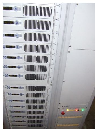
Рисунок 16. Внешний вид полупроводникового усилителя ISM.30K.174 производства фирмы «НПП Триада-ТВ».
