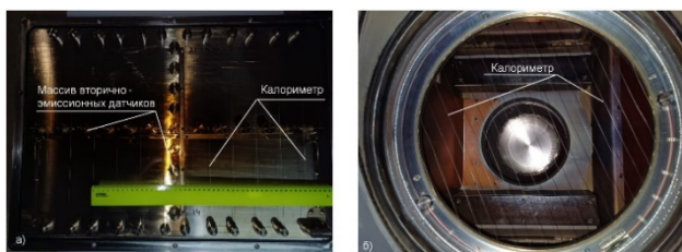
Рисунок 5. (а) – выходной калориметр с массивом вторично-эмиссионных датчиков, (б) – входной калориметр.
