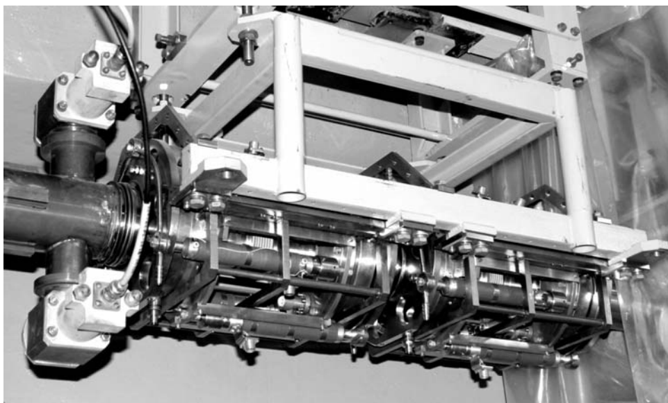
Рис. 11: Широкополосный резонатор - кикер обратной связи, установленный на ВЭПП- 4М.
