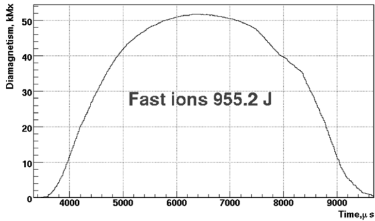
Рис. 5: Диамагнетизм плазмы в точке остановки быстрых частиц и вычисленное по нему энергосодержание быстрых дейтонов.
