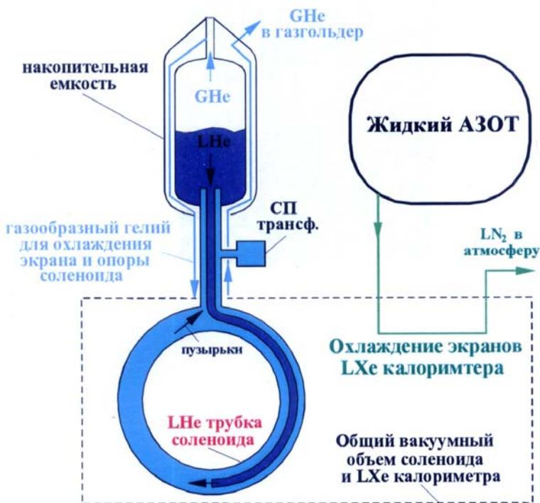
Рис. 3. Схема криогенной системы детектора КМД-3.
