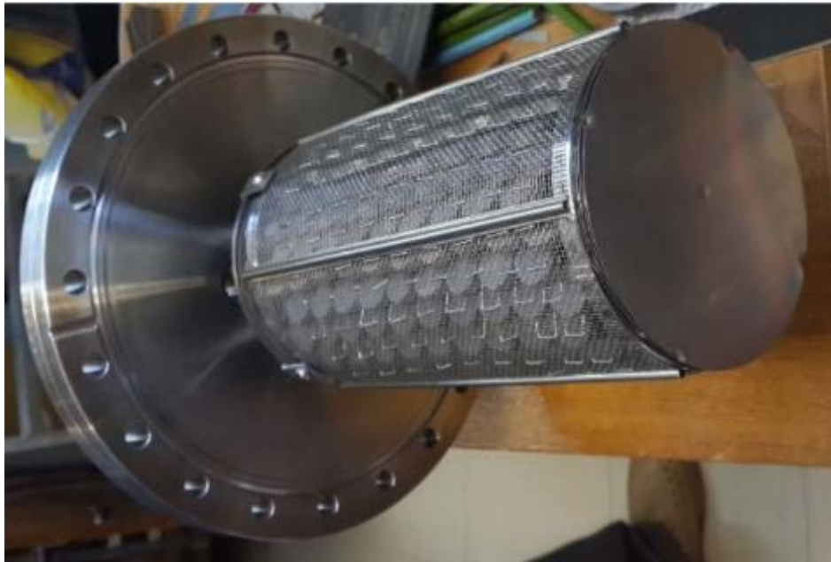
Рисунок 4.5. Вакуумный насос с внутренним нагревателем [28]
