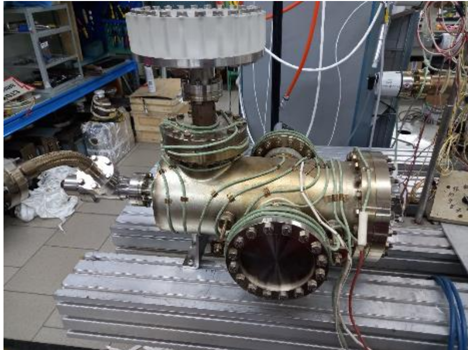
Рисунок 1.11 б). Фотография экспериментального стенда с размещенным на нем фланцевым соединением
