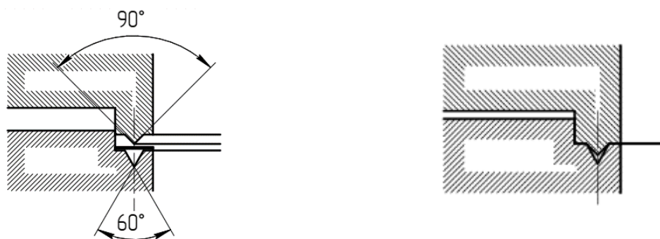
Рисунок 2.6. Канавочно-клиновое вакуумное соединение (слева - в разобранном, справа - в собранном виде) [59]
