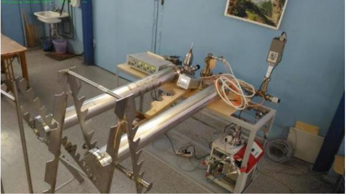
Рисунок 2.3. Фотография вакуумного стенда для испытания сварочных соединений
