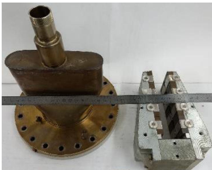
Рисунок 3.6. Диодный магниторазрядный насос с сильным магнитным полем производства ИЯФ СО РАН [75]
