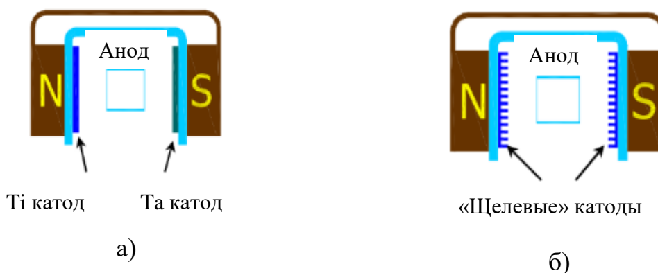
Рисунок 3.4. Магниторазрядный насос «Noble» диодного типа: а) - Ti и Ta катоды; б) - «щелевые» катоды [72]
