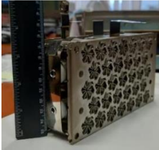
Рисунок 3.9. Электродный блок с катодами в виде «StarCell» [74]
