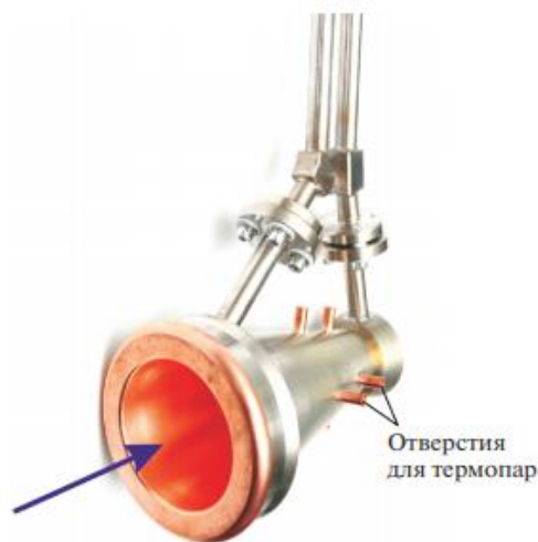
Рисунок 40 – Фотография цилиндра Фарадея. Направление распространения пучка ионов (атомов водорода) показано стрелкой
