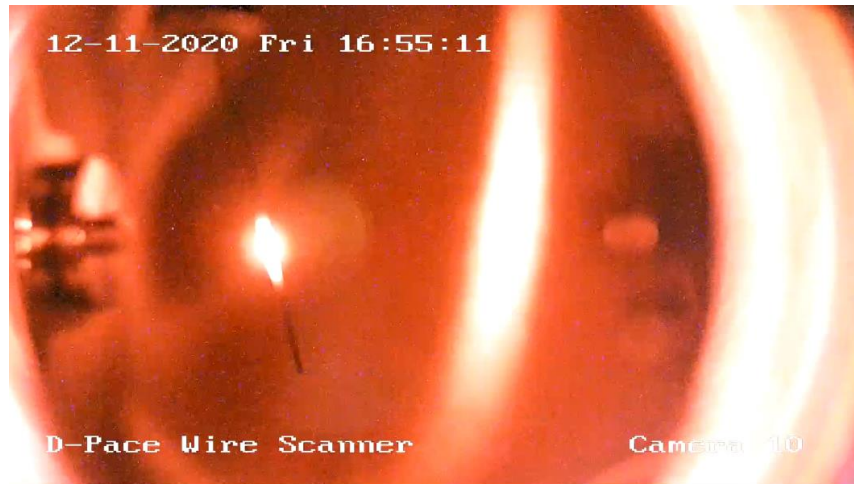
Рисунок 74 – Фотография проволочки сканера, пересекающего струю протонов при токе пучка протонов 3 мА
