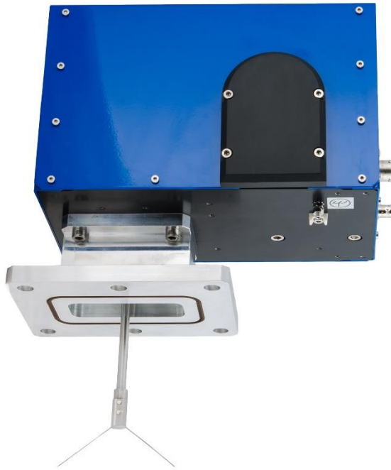
Рисунок 21 – Фотография проволочного сканера OWS-30
