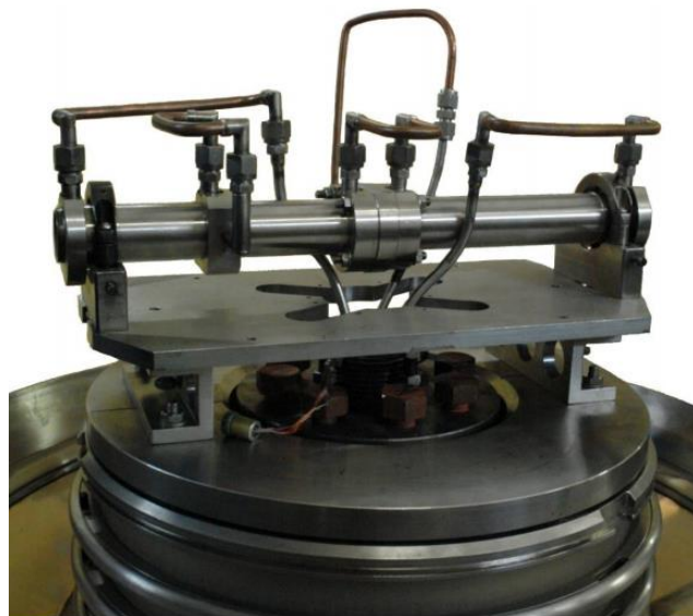
Рисунок 32 – Фотография газовой обдирочной мишени
