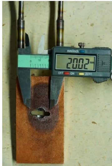
Рисунок 46 – Фотография охлаждаемой диафрагмы с щелью 5 \times 20 мм
