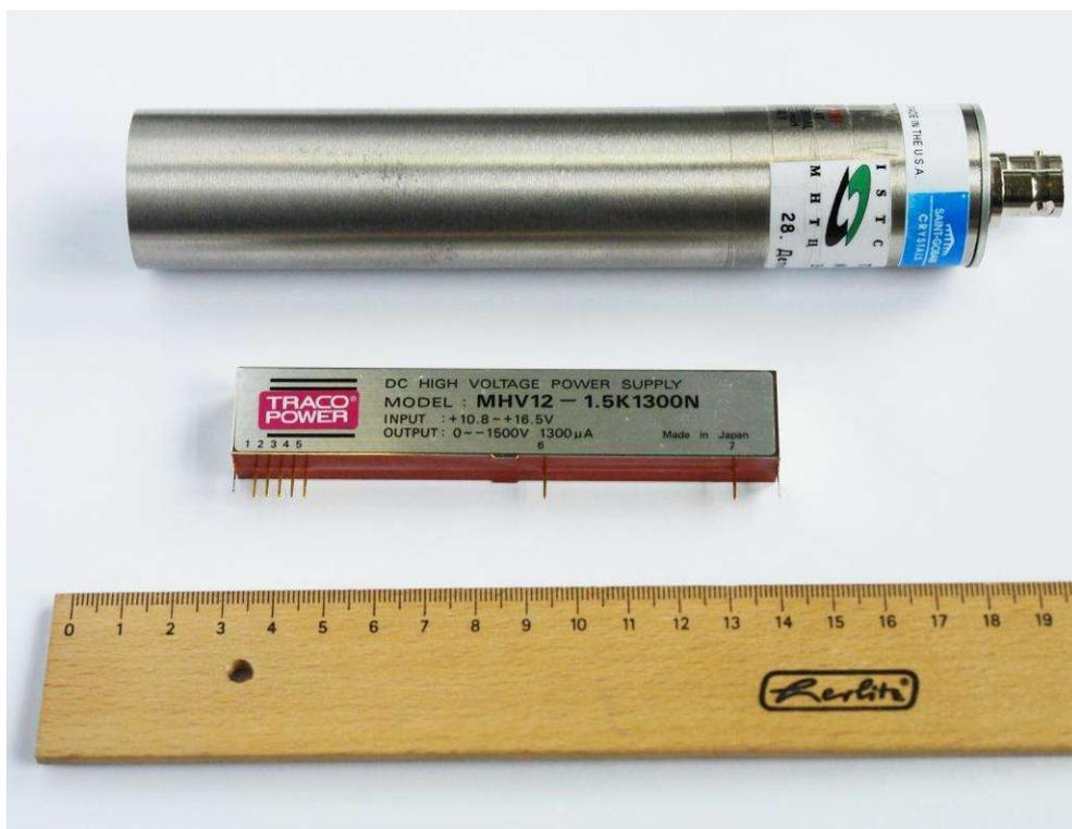
Рис. 18. Фотография детектора нейтронов и источника питания отдельно.
