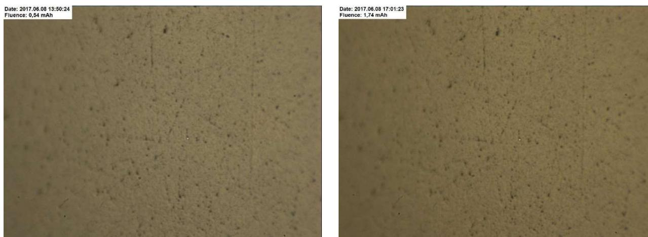
Рис. 58. Фотографии поверхности тантала образца № 5 с разными флюенсами облучения 2 МэВ протонами: 0,54 мА·ч (а), 1,74 мА·ч (б). Размер кадра  $9 \times 4 \text{ мм}^2$ .
