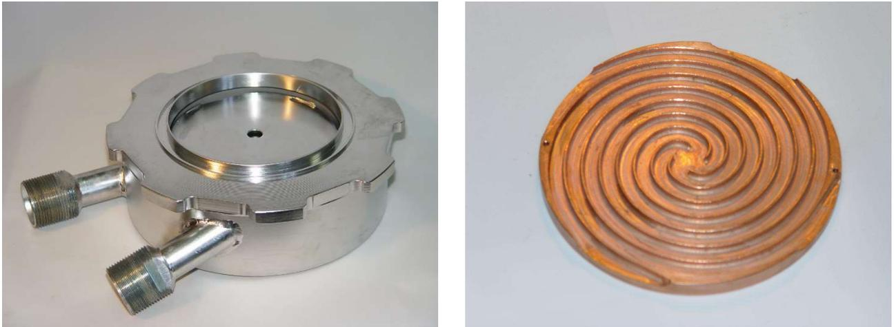
Рис. 13. Фотографии собранной мишени без приемника пучка (слева) и медного диска со стороны, охлаждаемой водой (справа).
