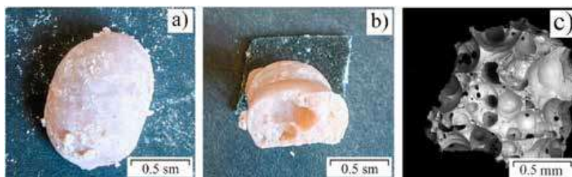
Изображение одиночной капли (а), капли с поперечным сколом (б) и сканирующая электронная микроскопия фрагмента (в) синтезированной высокоэнтропийной керамики в мощном пучке быстрых электронов. Предоставлено авторами статьи.
