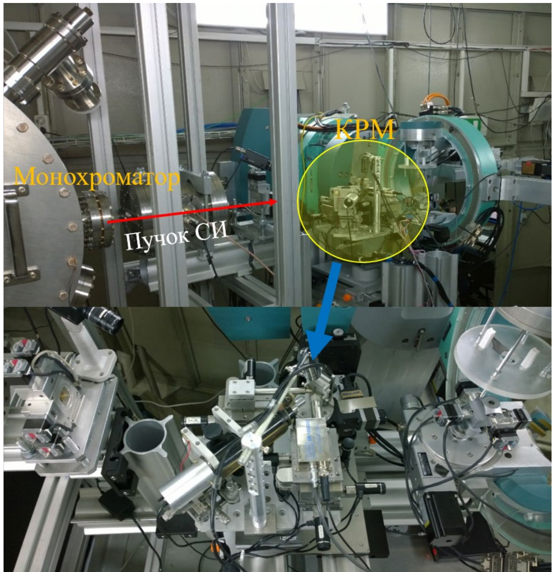
Рисунок 2.18 – Модуль КРМ на станции «РКФМ» УНУ «КИСИ-Курчатов» (НИЦ «Курчатовский институт», г. Москва)
