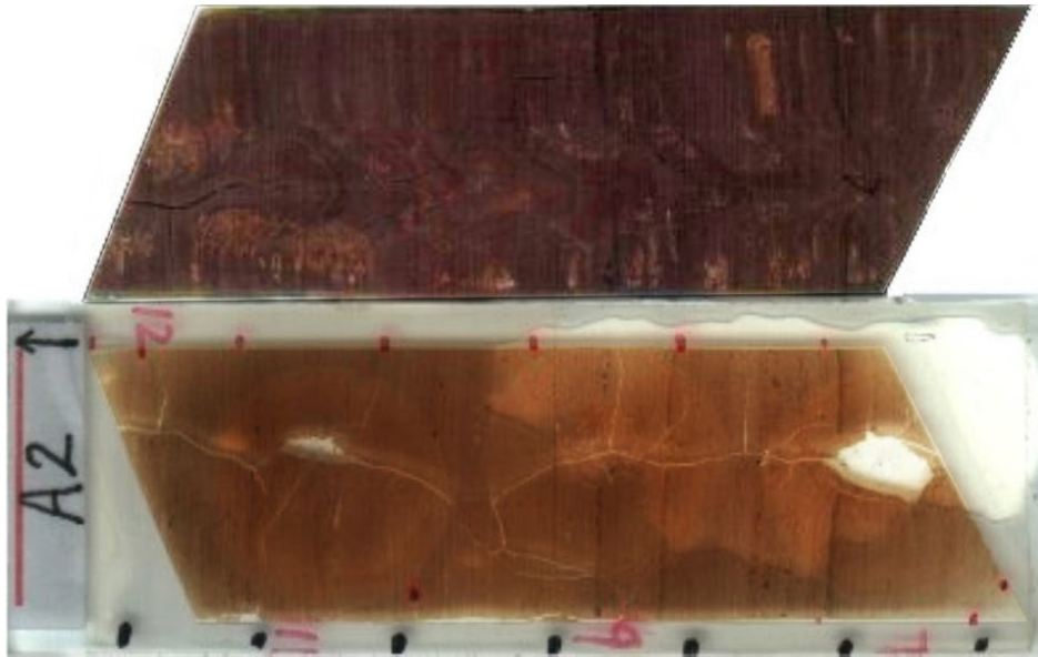
Рисунок 4.2 – Плоскопараллельная пластинка толщиной 2 мм (вверху), используемая для проведения микро-РФА-СИ и оптический шлиф (внизу), соответствующий анализируемой поверхности, изготовленные из твердого препарата донного осадка [75]
