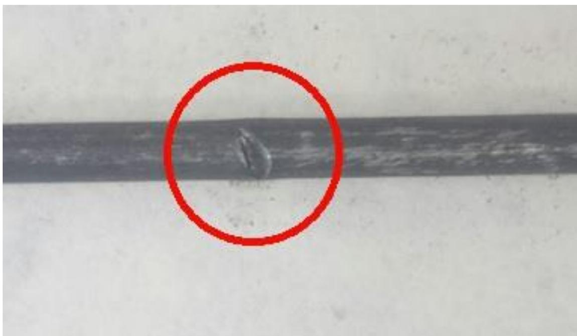
**Рисунок 37** – Фотография образца стали СВ08Г2С с нанесённым дефектом
