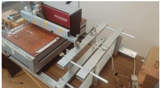
**Рисунок 34** – Фото установки для исследования распределения магнитного поля на поверхности ферромагнитных образцов цилиндрической геометрии
