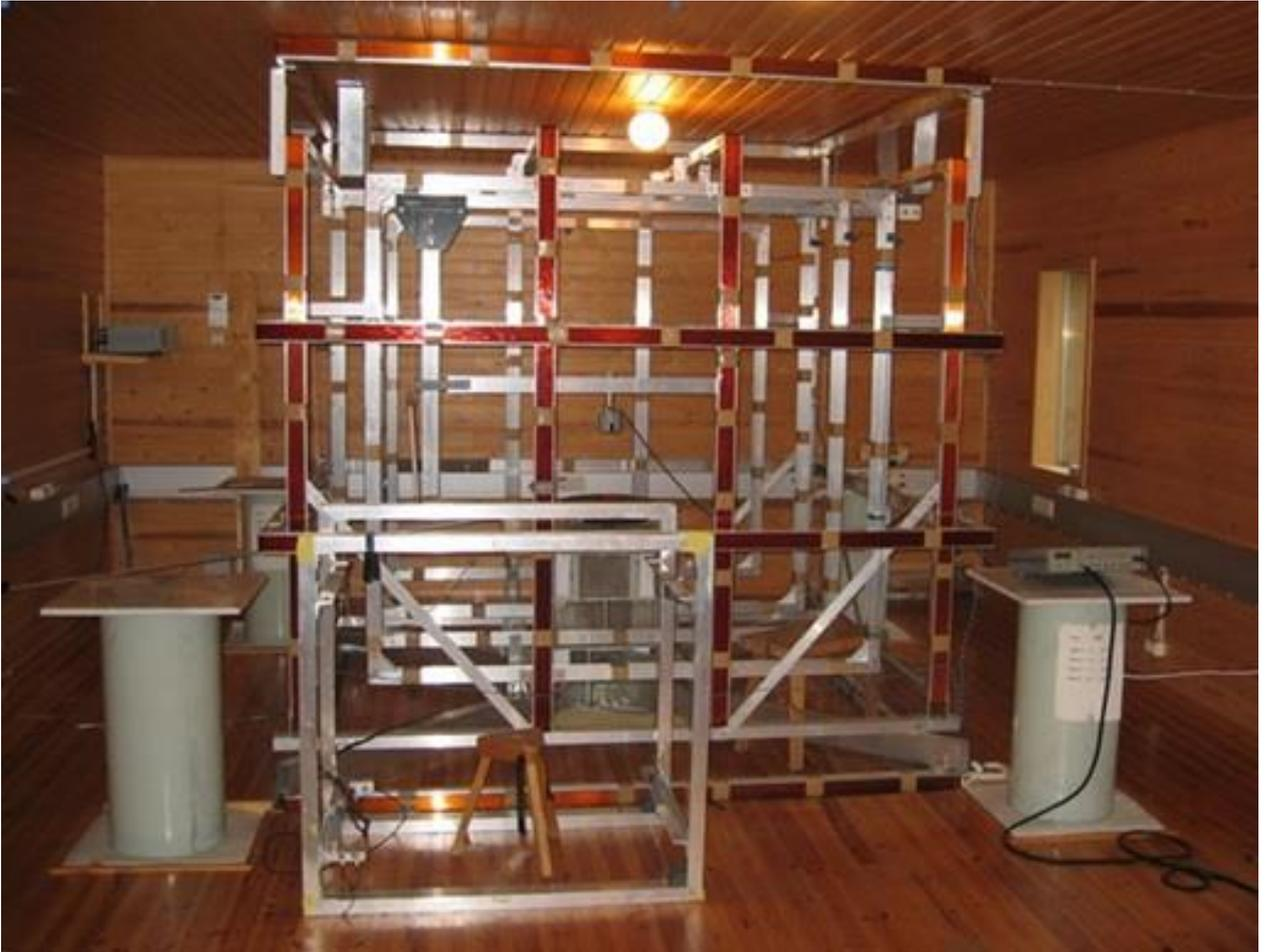
**Рисунок 2** – Калибровочные катушки для высокоточных векторных магнитометров
