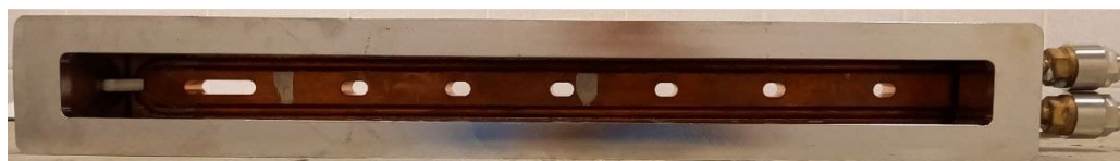
Рис. 6.4. Приёмник излучения из вивглера. Слева щель в которую поступает СИ из вивглера.
