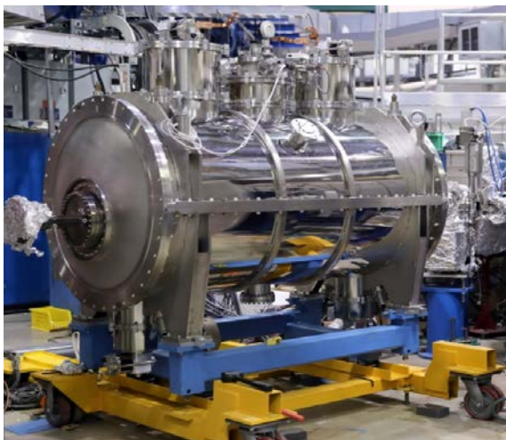
Рис. 15. Внешний вид криостата 7.5 Тл 15-полюсного вигглера LSU-CAMD.
