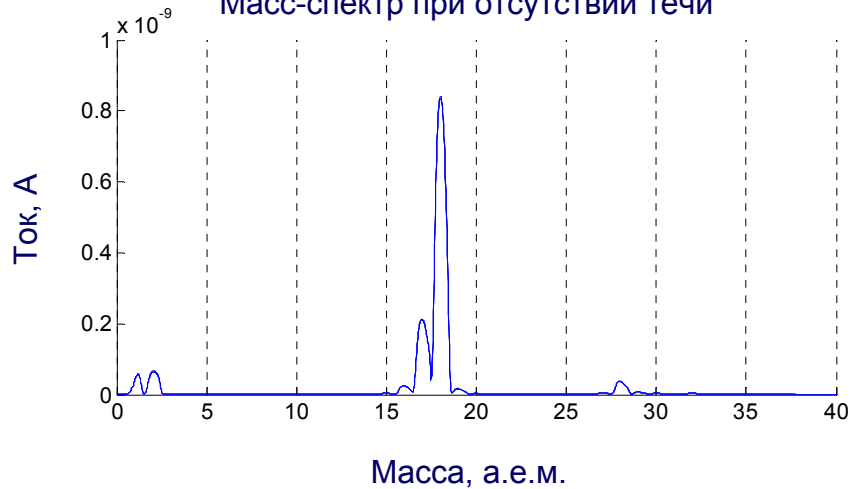
Масс-спектр при отсутствии течи
