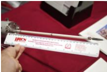
Hidden Analytical ESPion. Промышленно выпускаемый лентгмюровский зонд.
