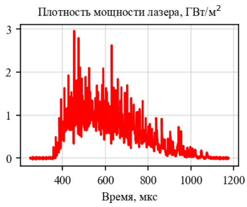
Рис. 22. Временной профиль нагревающего лазера в эксперименте с В 4 С
