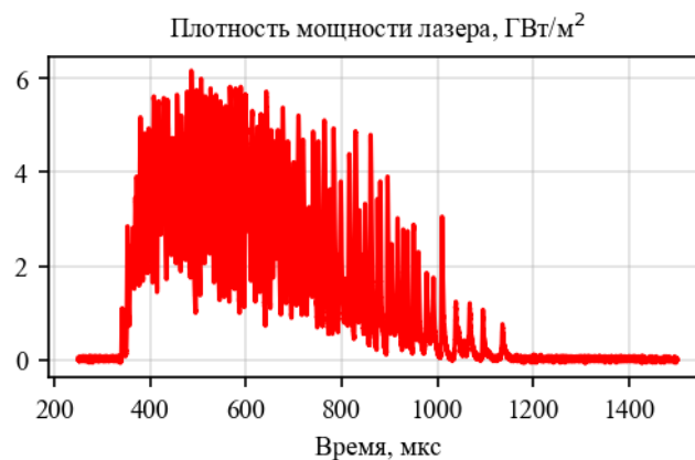
Рис. 20. Временной ход интенсивности лазера, пересчитанный в плотность мощности для однородного распределения.
