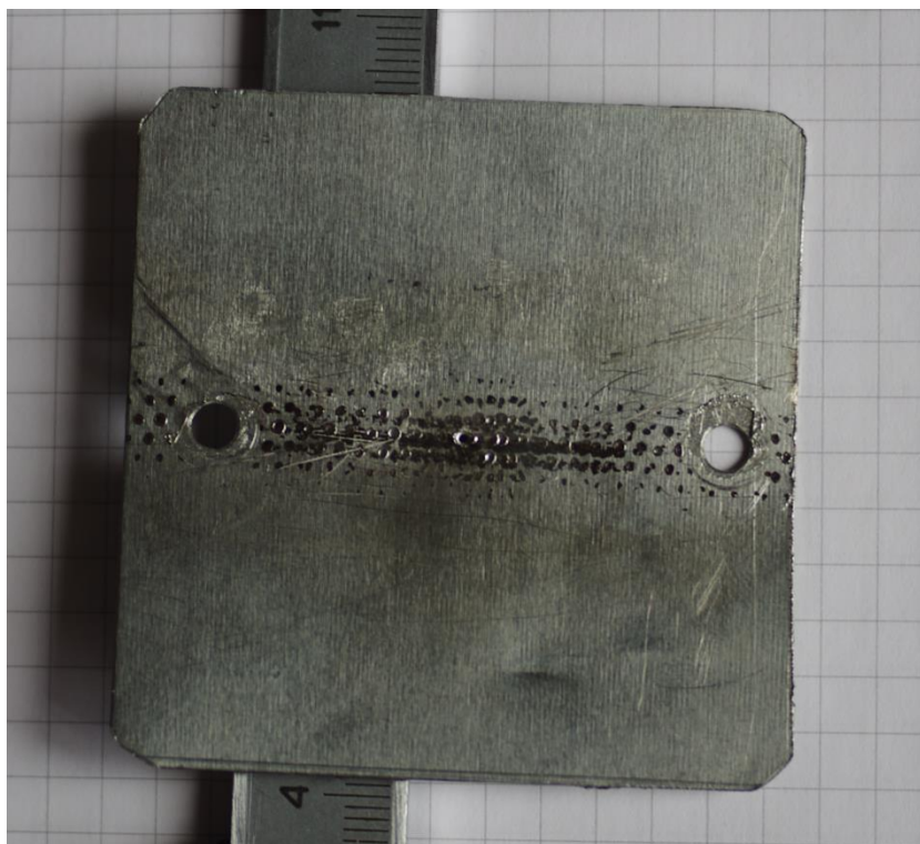
Рисунок 29 — Фотография молибденовой пластины, используемой в качестве сепаратора пучка после экспериментов.
