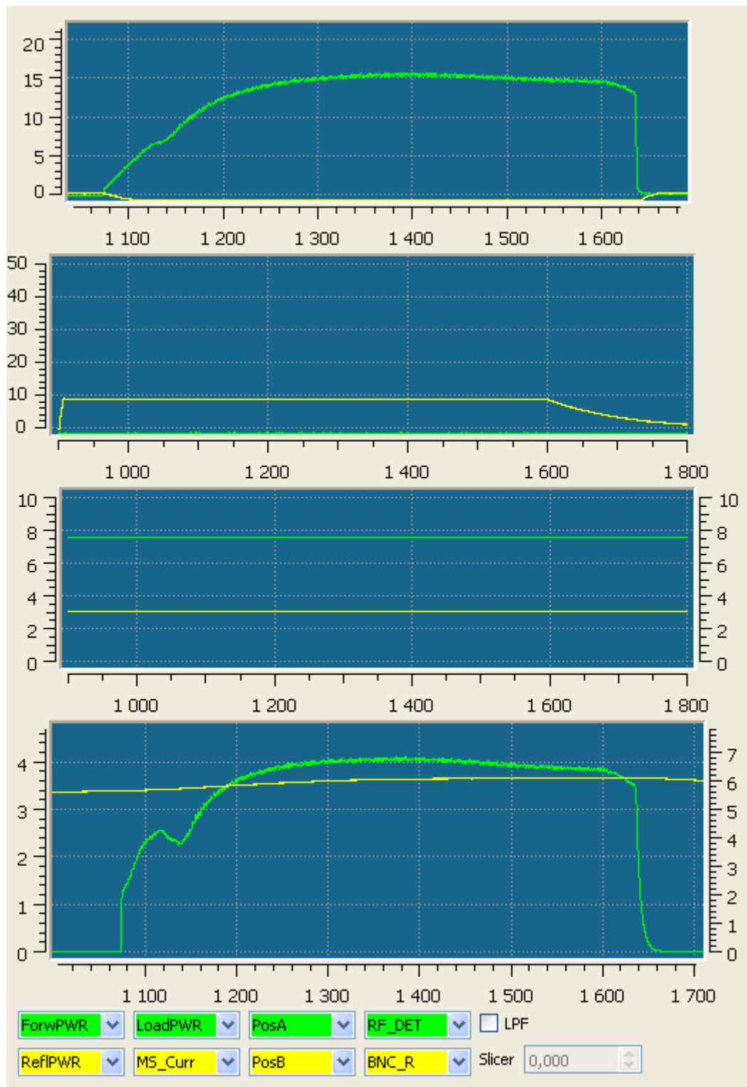
Рис. 4.1.1. Данные, измеряемые при согласовании ВЧ генератора; сверху вниз: прошедшая мощность (кВт), ток системы магнитного поля (А), уставка подстроечных конденсаторов (В); напряжение на ВЧ антенне (кВ); сигнал с датчика давления в камере (В). По горизонтальной оси указано время в миллисекундах.
