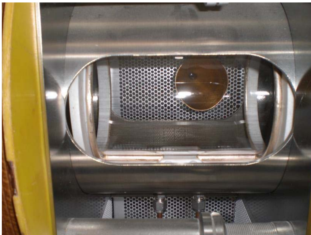
Рис. 2.1.2. ВЧ антенна Nagoya Type III: медная трубка \varnothing 6 \times 1 \text{ мм} , индуктивность – 0.3 \mu\text{Гн} , диаметр – 110 мм, длина – 160 мм.
