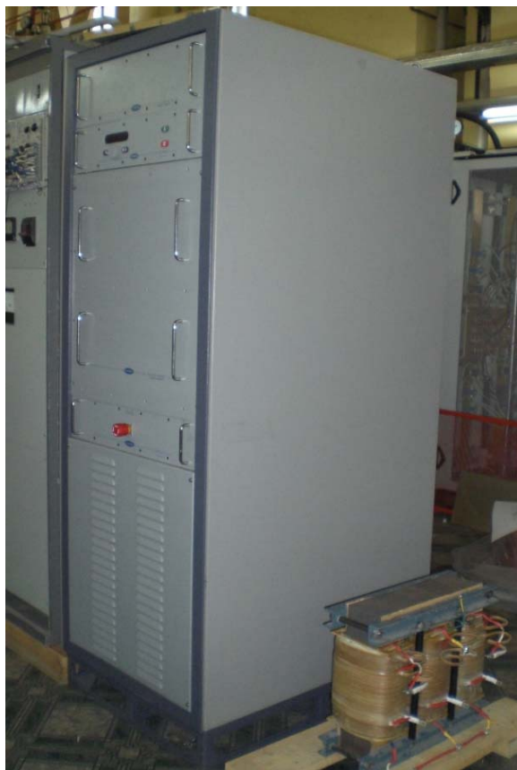
Рис. 2.3.1. Промышленный ВЧ генератор COMDELL CX25000-S.
