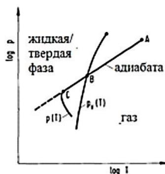
Рисунок 1.2 – Линия границы фаз газа и жидкости  $p_v(T)$  и линия расширения газа  $p(T)$  на фазовой диаграмме.
