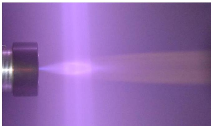
Рисунок 3.7 – Визуализация струи Ar с помощью электронного пучка.
