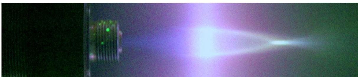
Рисунок 3.5 – Фотография струи азота за сверхзвуковым соплом, возбужденной расфокусированным электронным пучком.
