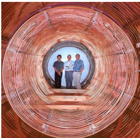
Рис. 1. Фотография первичной обмотки ускорительной трубки.
