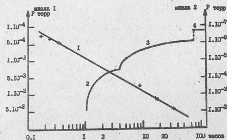
Рис.2. Увеличение давления в кожухе Б-5 при выключенных откачных агрегатах (шкала I линия I) и уменьшение давления во время откачки (шкала II — кривые 2, 3, 4).
