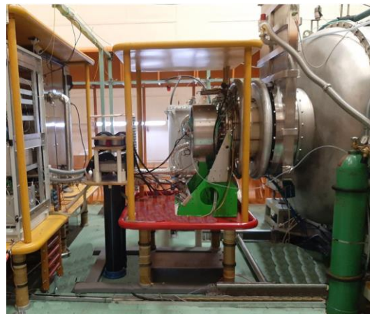
1,5 А ионный источник и вакуумный бак НЭТ на высоковольтной платформе инжектора
