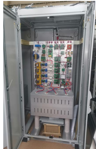
Четырехканальное дуговое питание в сборе: в каждом шкафу размещено питание двух дуговых генераторов плазмы.
