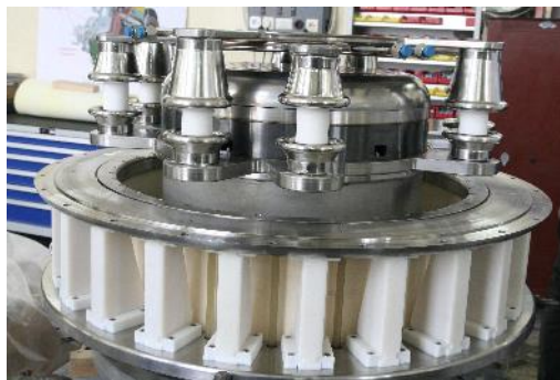
Ионно-оптическая система 9 А источника
