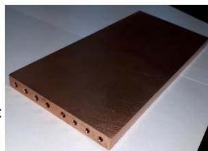
Модель сегмента первой сетки ИОС: ширина щели 8.0 мм, каналы охлаждения 4 мм.
