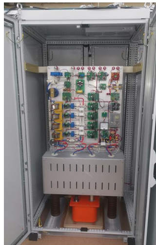
Четырехканальное дуговое питание в сборе: в каждом шкафу размещено питание двух дуговых генераторов плазмы.
