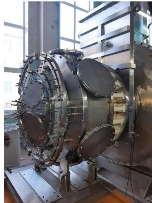
Расширительная камера и ионно-оптическая система установлены на вакуумный объем стенда в зале 20Г-101
