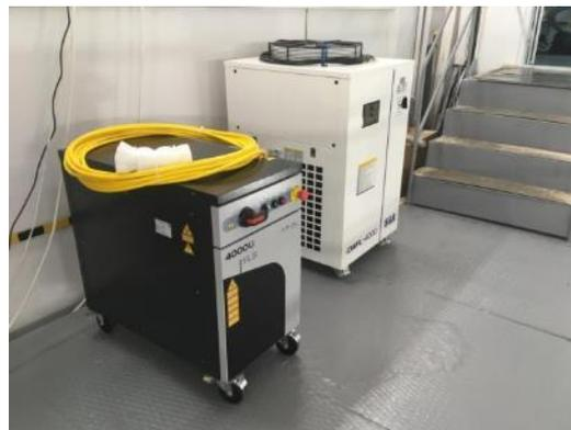
Новый мощный волоконный лазер, способный работать в непрерывном, импульсном и импульсно-периодическом режимах
