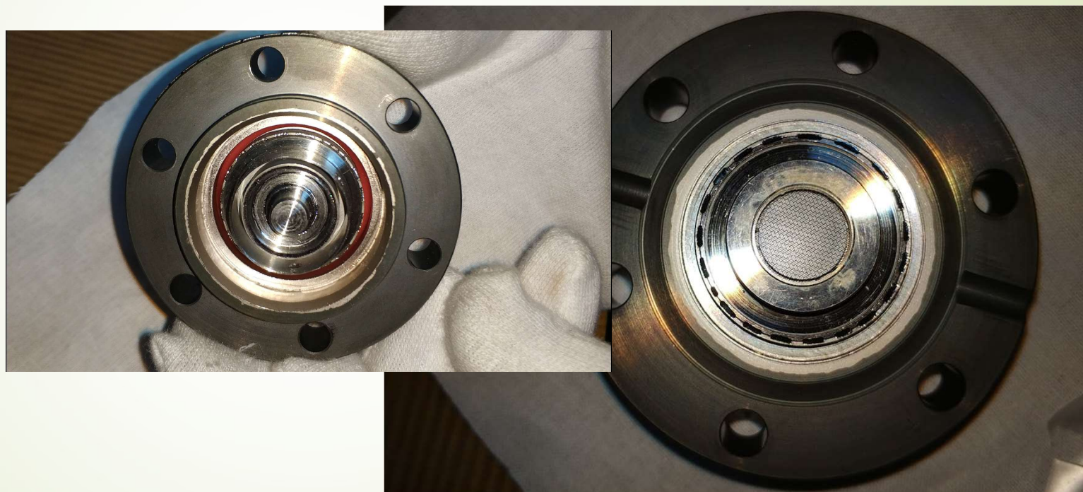
Катодный узел для инжектора СКИФ (изготовитель – НПП Торий)
