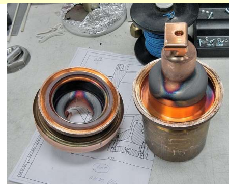
Ввод мощности (распилен)
