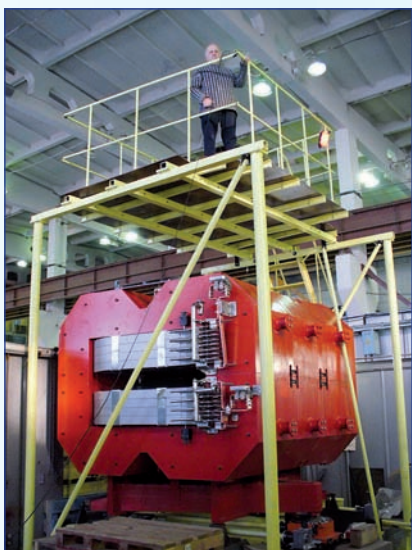
90-тонный радиационно-стойкий дипольный магнит для ускорительного тяжело-ионного комплекса в GSI (Германия).
