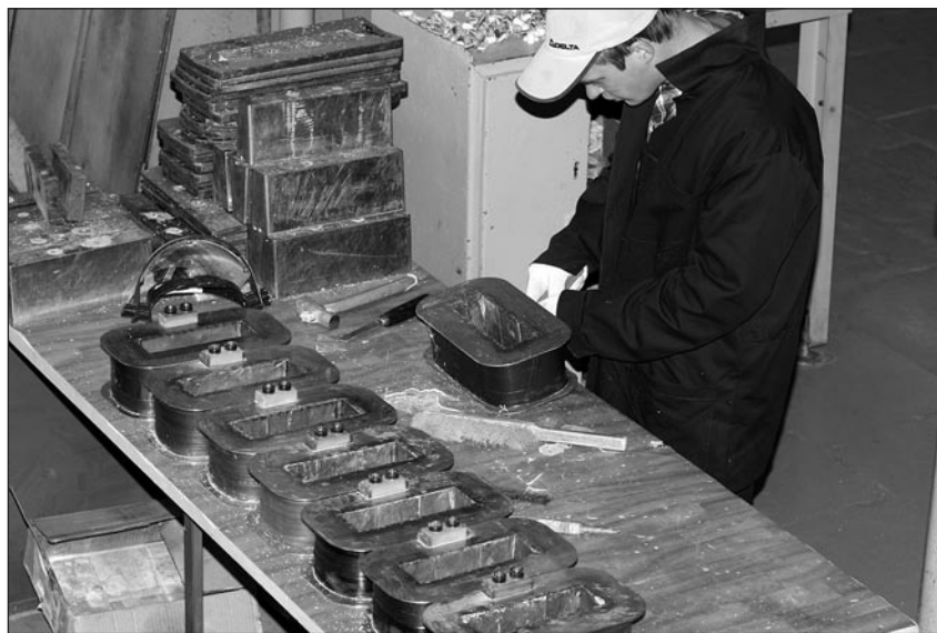
Зачистка катушек после заливки эпоксидным компаундом производится вручную.
