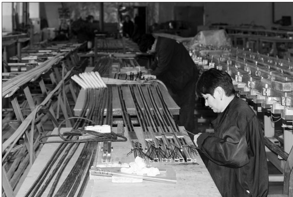
Изоляционная обмотка сверхпроводящих шин требует предельной аккуратности.
