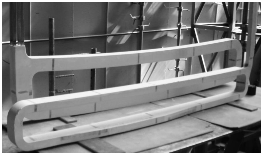
Рис.3.8. Катушки BD и BF диполей после запечки.
