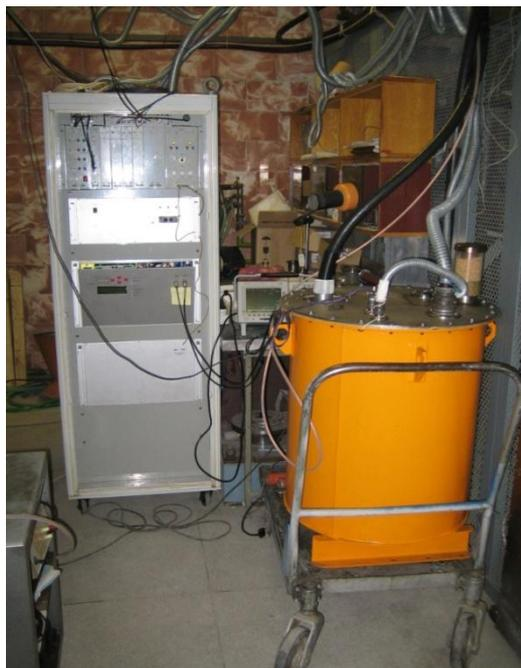
Рисунок 2.19. Первая версия энергоблока для ЭЛС с высоковольтным источником -60кВ 15кВт.
