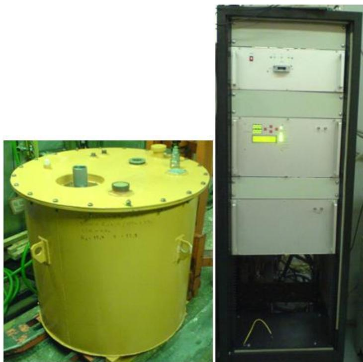
Рисунок 2.20. Стойка и бак высоковольтного трансформатора источника 60кВ 30кВт.
