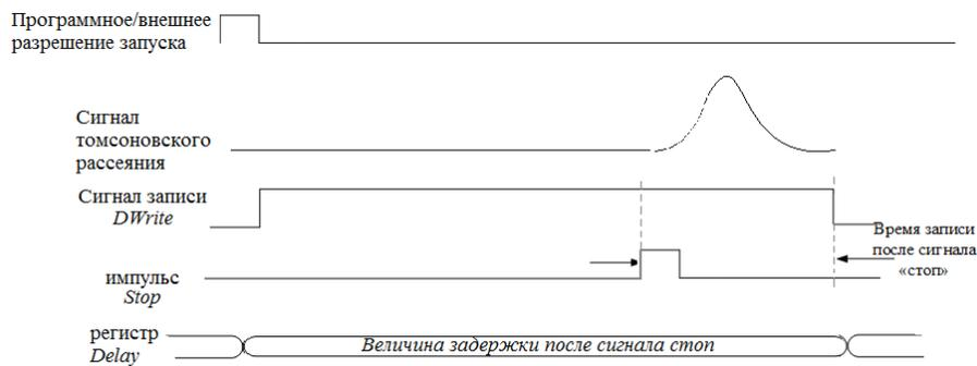
Рисунок 3.18. Формирование сигнала записи в режиме с привязкой к внешнему запуску.
