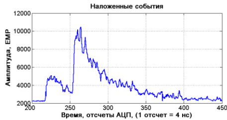
Рисунок 1. Оциллограмма выходного сигнала детекторного модуля на основе сцинтиллятора ВГО ( \varnothing 80 мм, 100 мм) и ФЭУ Photonis XP3312В с диаметром фотокатода \varnothing 76 мм при появлении наложенных событий, зарегистрированная при помощи 14-разрядного АЦП с частотой дискретизации 250 МГц.
