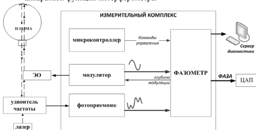
Рисунок 2. Схема одноканального ДИ с искусственной фазовой модуляцией зондирующего излучения и его измерительный комплекс. В состав комплекса входят: модулятор , формирующий сигнал синусоидальной формы, поступающий на электрооптическую ячейку ЭО, фотоприемник , преобразующий выходной сигнал интерферометра в электрическую форму, фазометр , выполняющий процедуры фиксации текущих амплитудных значений сигналов модулятора и фотоприемника, их оцифровки, а также коррелированной обработки результирующих цифровых отсчетов с целью восстановления характера поведения во времени набега фазы \Delta\varphi , обусловленного изменениями плотности плазмы.
