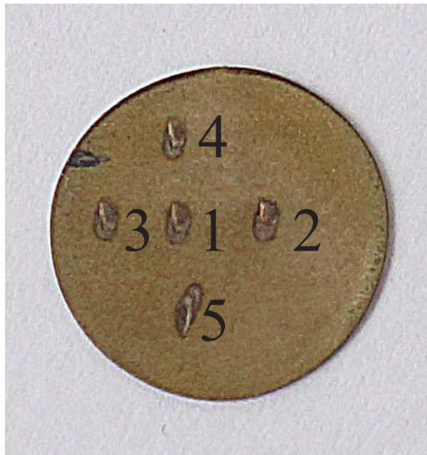
Рис. 53: Вольфрамовый образец. Синхротронное излучение проходило через образец в точке 1. В точки 1, 2, 3 и 4 последовательно фокусировалось лазерное излучения при экспериментах по изучению роли изгиба образца. В точку 5 лазерное излучение фокусировалось в другой серии экспериментов.
