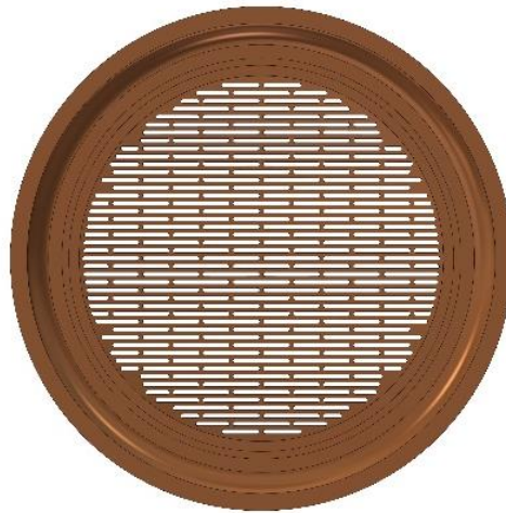
Рисунок 2.18 – Начальный вариант плазменного электрода: многоапертурная эмиссионная область с щелевыми отверстиями со смещением
