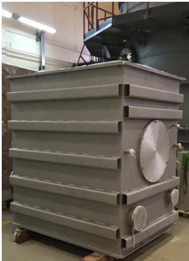
Рисунок 3.6 – Вакуумная камера после отжига: позади камеры видна вакуумная печь
