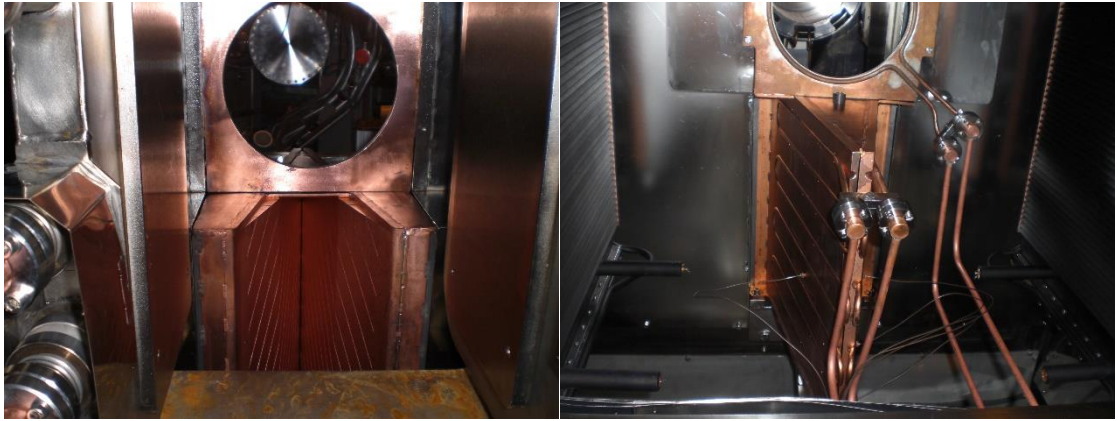
Рисунок 4.19 – Приемники ионов и диафрагма в вакуумной камере инжектора: Слева – вид со стороны поворотного магнита (по ходу пучка), справа – со стороны калориметра (обратное направление)
